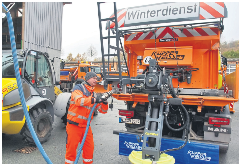
Gut gegen Glätte: Straßenwärter Thomas Gerold betankt ein Räumfahrzeug mit der Magnesiumchlorid-Lösung, die mit dem Streusalz vermischt auf die Straße gebracht wird. FOTOS: ARMIN HASS
